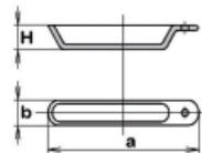
Nahita le ofrece esta pequeña navecilla de combustión fabricada en porcelana sin esmalte lo que le permite soportar temperaturas extremas de hasta 1350°C. Ideal para procesos de combustión o para fundición de metales.
