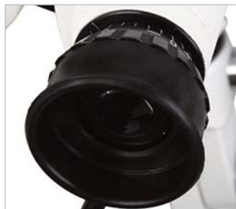
Oculares con anteojeras para reducir las interferencias producidas por la entrada de luz
