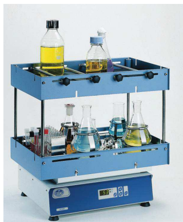
Plataforma doble código 3001011 adaptada al agitador código 3000974.
