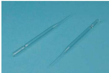
**1** | fabricadas en vidrio, con punta larga y fina, y con estrangulación en el tubo de aspiración apta para la colocación de un tapón de algodón.
