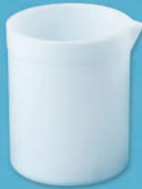
1 | Los vasos de PTFE son una excelente opción para reemplazar a los vasos de cristal, gracias a su alta resistencia a la rotura, soportan rangos de temperatura muy amplios (-200 a + 260°C, pudiendo soportar puntualmente temperaturas hasta 340°C) y son prácticamente inertes a productos químicos.
