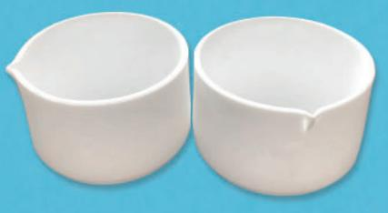
1 | Para evaporar sustancias como ácidos o bases fuertes, agua regia, etc, a cualquier concentración.
