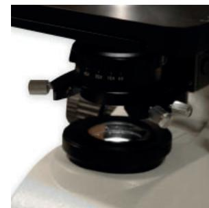
Sistema de traslación de la platina y ajuste de enfoque.
