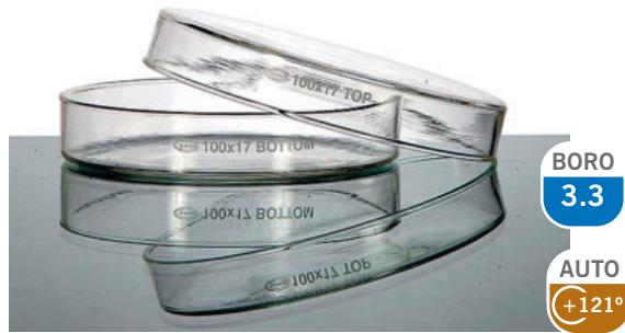
1 | Fabricadas en vidrio borosilicato. Autoclavables a 121 °C
