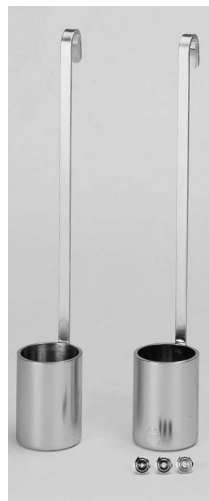
Copas con asa. Modelos DIN 53211 N° 4 y Ford ASTM D-1200.
