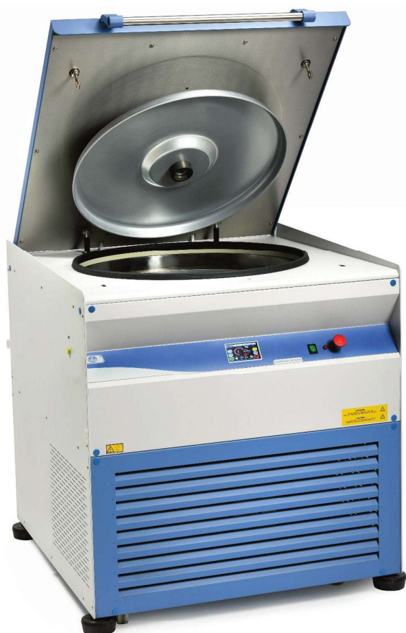
Imagen de la centrífuga con cabezal y vasos con doble compartimento para bolsas de sangre triples o cuádruples de 500 a 800 ml.
